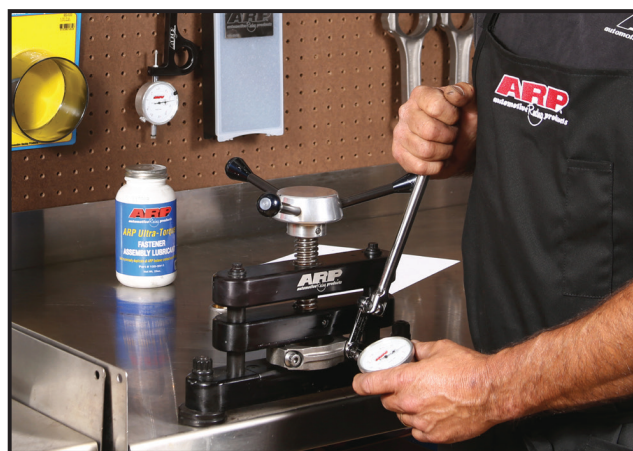
コンロッドボルトの伸びゲージは、シリアスなエンジン・ビルダーの持っている工具の中でも最も大切なもののひとつである。これはロッドのサイズを変えたりするときやエンジンに組み込むときのトルクを設定するときなどに、また、まだ使用中でもボルトの状態を把握するのに重宝する。
